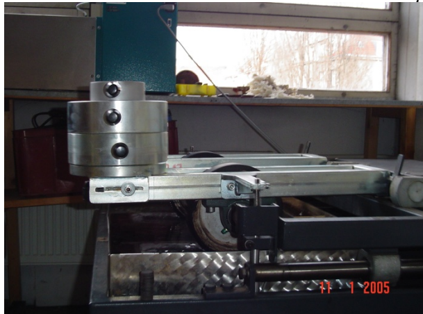
Obr. 2 a 3 Malé zkušební zařízení s zařízením pro přípravu vzorků „lamelový zhutňovač“
