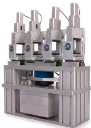
Obr. 7 a 8 Čtyřbodové zkušební zařízení se zařízením pro přípravu vzorků „segmentový zhutňovač“
